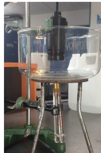
Figur 5: Forsøgsopstilling for forsøg med absorption af \gamma -stråling.
